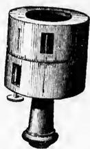
ont le même rayon : le supérieur est mobile, et deux roues dentées permettent de le faire mouvoir aussi lentement que l'on veut, au moyen d'un bouton. Il porte quatre ouvertures, donnant deux plans de visée rectangulaires et une graduation de  $0^{\circ}$  à  $360^{\circ}$ ; le cylindre inférieur n'a qu'une fenêtre et une pinnule, disposées suivant un plan diamétral. Un vernier permet d'évaluer les angles à deux minutes près.
