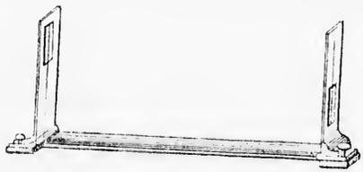
une fente et une fenêtre. Un des bords de la règle est la ligne de foi ou de collimation; cette droite correspond au plan de visée.
