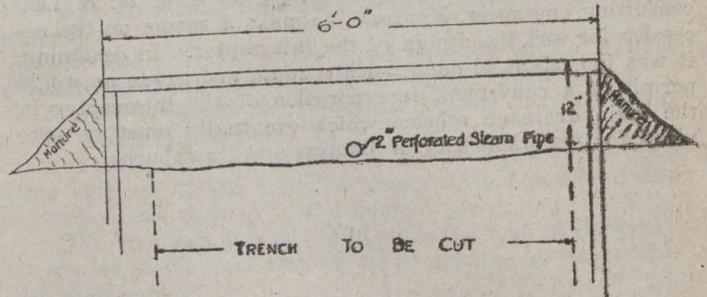
FIG. 4—THAWING GROUND CHEAPENED EXCAVATION
