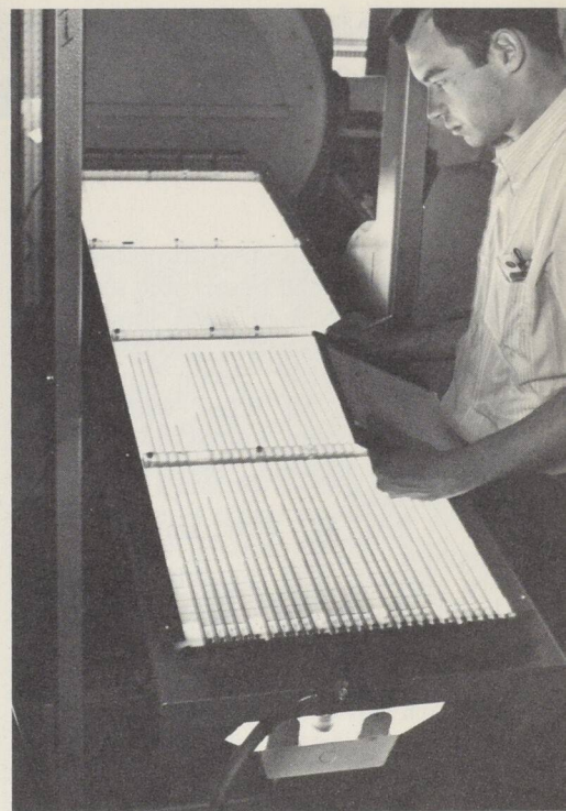
Bart Robinson lit les pressions données par un capteur expérimental devant servir en mécanique des fluides.
