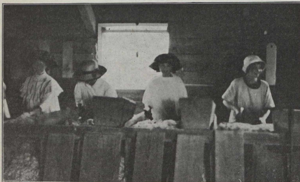
Cobbing Asbestos, Black Lake, P.Q.
