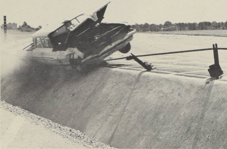
Test car crashes through wire cable roadside barrier as part of highway safety study. • Une voiture heurte une glissière spéciale pour autoroutes lors d'essais sur la sécurité routière.
