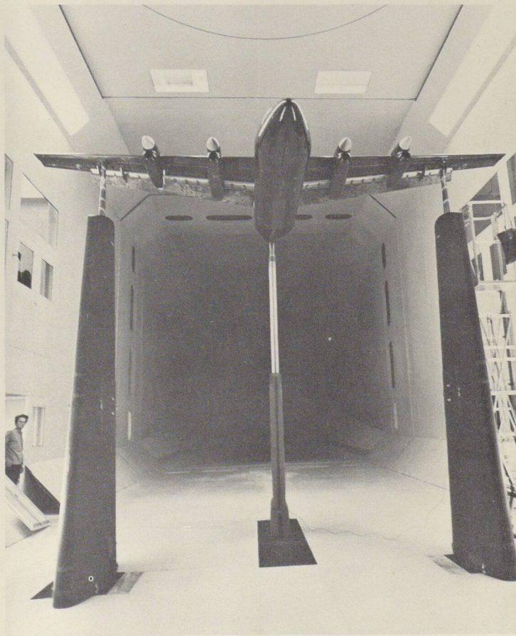
DeHavilland's DHC-7 model under test in a wind tunnel at the National Aeronautical Establishment. • Maquette de l'avion De Havilland DHC-7 aux essais dans une soufflerie de l'EAN.
