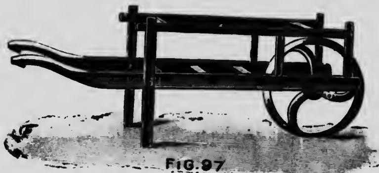
Fig. 97. Brouettes pour le transport des palettes de tourbe au terrain de séchage.
