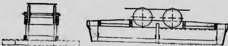
Fig. 102. Wagonnet de Anrep pour le transport des palettes de tourbe avec la machine à tourbe N° III.
