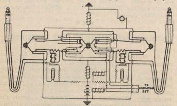
FIG. I.-DIAGRAM OF CORD CIRCUITS.
