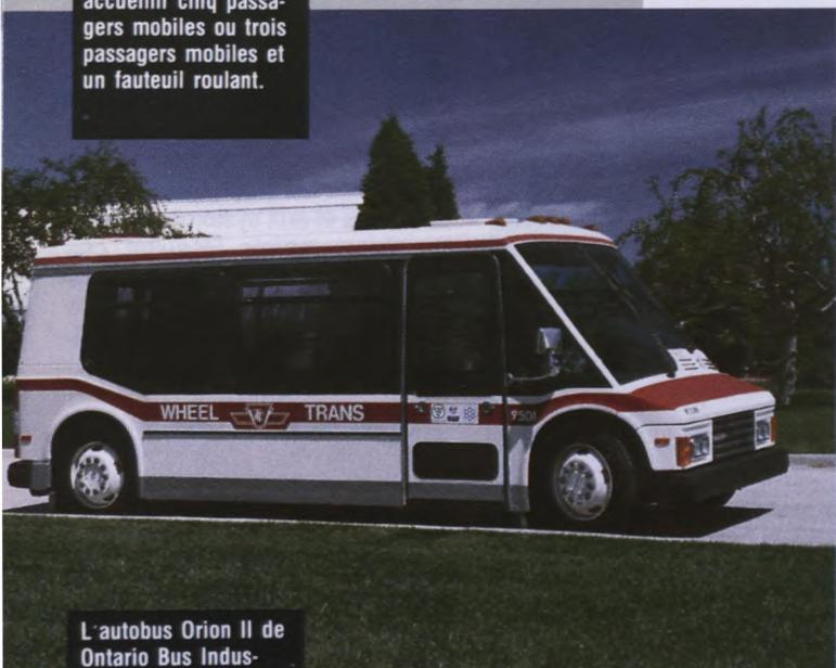
L'autobus Orion II de Ontario Bus Industries, conçu pour les personnes handicapées, est capable de s'abaisser près de la chaîne de trottoir pour faciliter l'accès.
