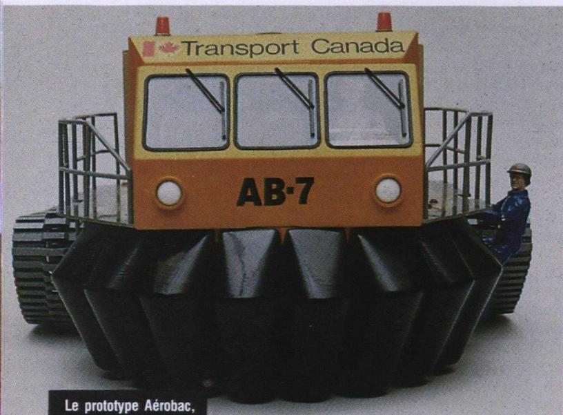
L'Aérobac, conçu et mis au point par le Centre de développement des transports, est une combinaison ingénieuse de l'aéroglesseur et du véhicule à traction terrestre. Sur l'eau, il flotte sur un coussin d'air; sur un terrain rocheux, il se sert de ses chenilles.
