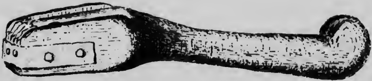
Figure 1. Gouge à panier mohican.
