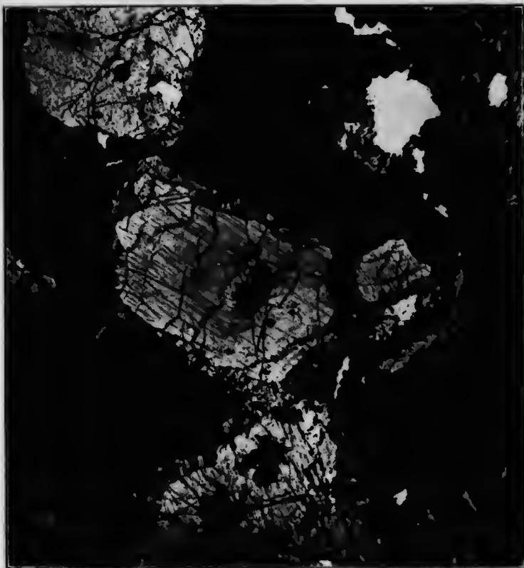
Microphotographie de minerai de fer de Pusey, montrant les individus de pyroxène enclavés dans le minerai de fer avec une couronne d'amphibole entourant le pyroxène, lot 35, concession IV, canton Glamorgan. Lumière ordinaire.
