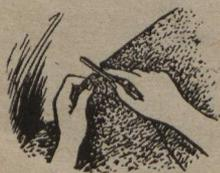
Une petite lame de rasoir protégée par une garde dentelée et avec une poignée, découd facilement et sûrement. La garde force la couture à s'ouvrir tandis que la la-
