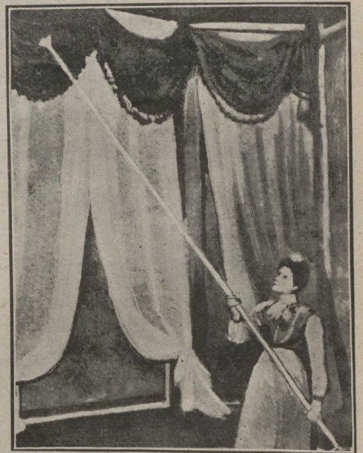
Epoussetage des rideaux par la lance à air comprimé
