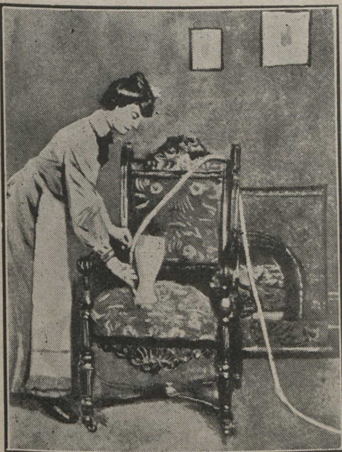
Epoussetage d'un fauteuil avec l'appareil à main à l'air comprimé
