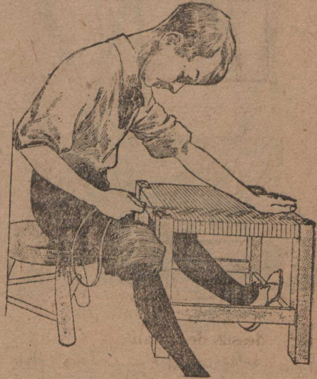
Tissage du siège d'un tabouret avec des bandes de roseau.
