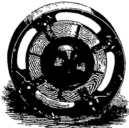
TICE'S DYNAMOMETER PULLEY.—Fig. 2
