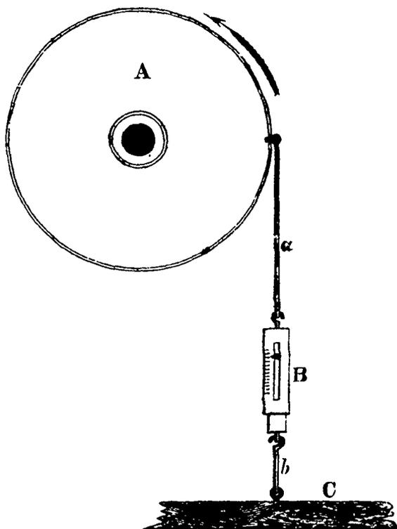
TICE'S DYNAMOMETER PULLEY—Fig. 3.
