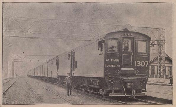
ST. CLAIR TUNNEL ELECTRIC LOCOMOTIVE IN TERMINAL YARDS.
