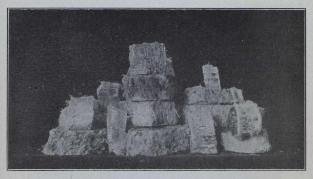
HIGHEST GRADE CRUDE ASBESTOS ORE.
