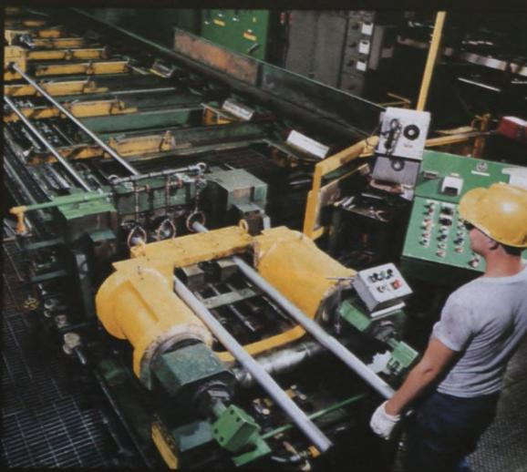
▲ Détection des pailles ou autres défauts de surface difficilement visibles, à l'aide de matériel de contrôle non destructif Roto Bar.
