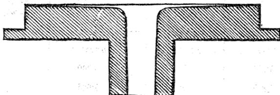
Cet ajutage, imitant la veine contractée, dont nous donnons le dessin, grandeur naturelle, dans la fig. 2 $\frac{1}{2}$ , a un pouce de long; au petit bout sa perce a un diamètre de 0.313 pouce, tandis qu'à sa jonction avec le réservoir la section transversale peut être regardée comme infiniment grande, comparativement à la petite base.
