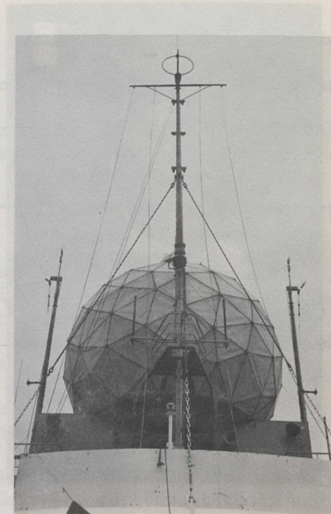
Der Radarschirm ist ein typisches Merkmal des Wetzerschiffs "Quadra", welches mit der wohl stärksten Regensuchanlage der Welt ausgerüstet ist.
