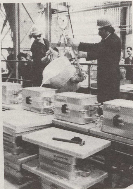
Des opérateurs versent l'aluminium dans un moule à l'intérieur d'une fonderie du groupe de SNC.
