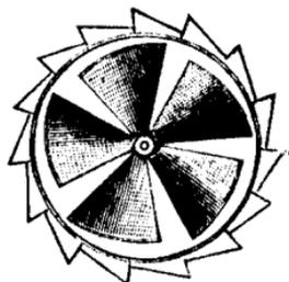
L'une des principales propriétés de ce ventilateur c'est qu'il est mis en mouvement, non seulement par le moindre vent, mais aussi par la différence de température de l'intérieur et de l'extérieur de la bâtisse.
