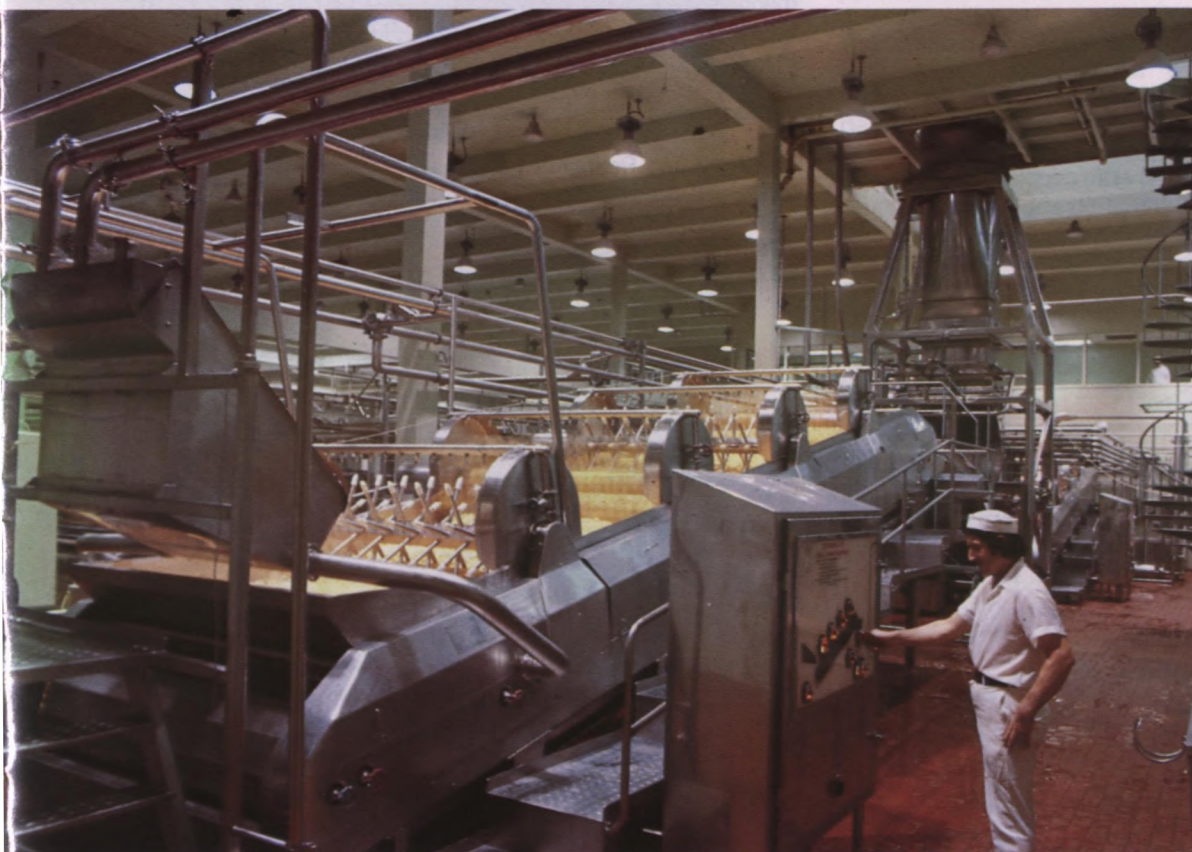
Bassin de fabrication du fromage Cheddar (Coopérative agro-alimentaire Agropur)
