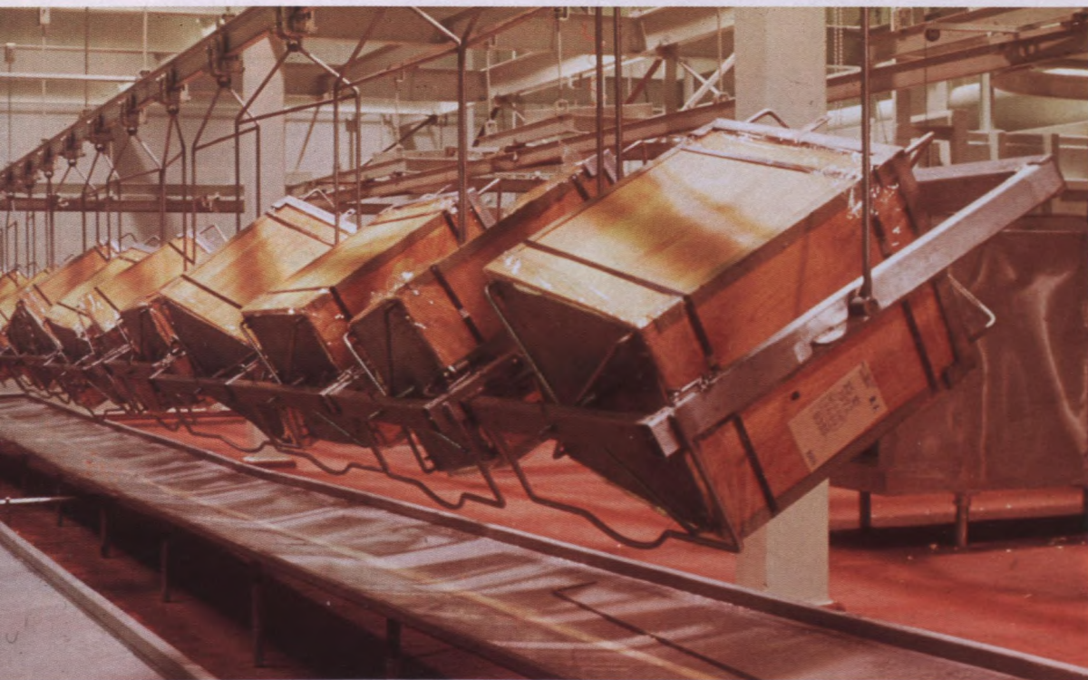
Fromage en vrac en procédé d'égouttement (boîtes de 275 kg chacune) (Coopérative agro-alimentaire Agropur)
