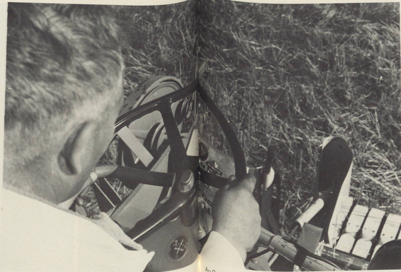
Gordon Miller, departmental assistant in agricultural engineering at the University of Saskatchewan, operates a combine while keeping an eye on the grain loss meter beneath the steering wheel. The meter indicates the number of bushels of grain being lost per hour as a result of incomplete separation. Excessive losses can be reduced by slowing down the forward motion of the combine. • M. Gordon Miller, assistant de génie agricole à l'Université de la Saskatchewan, surveille le compteur de perte de grain qui est placé en-dessous du volant de la moissonneuse. Ce compteur indique le nombre de boisseaux de grain perdu par heure par suite d'un battage incomplet. Les pertes excessives peuvent être diminuées en réduisant la vitesse de translation de la moissonneuse.
