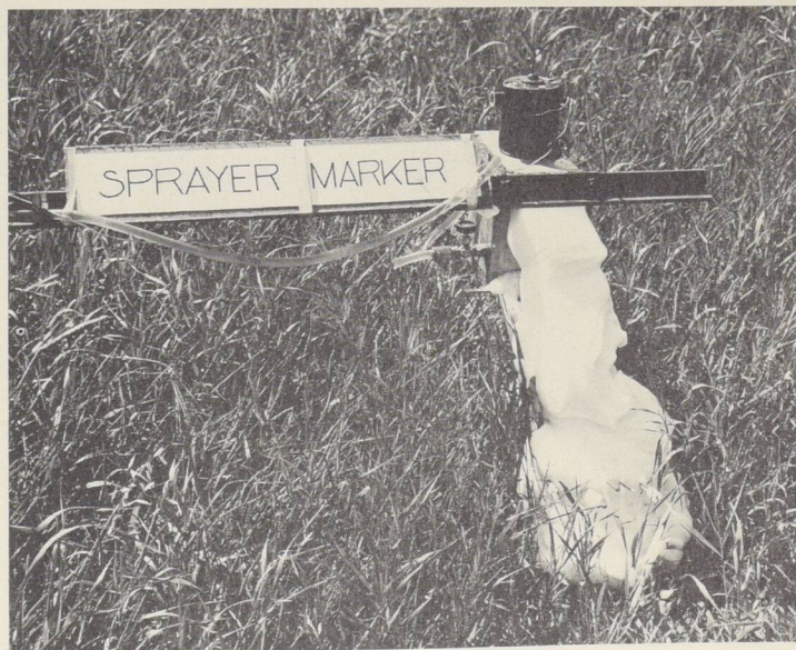
A sprayer marker developed by the Division of Control Engineering utilizes a mechanical foam generator which provides a visible mark on the crop already sprayed. This enables the operator to minimize overlap and avoid missing areas to be sprayed. • Une traceuse, mise au point par la Division des techniques de commandes, produit une mousse servant à délimiter la partie de la récolte ayant déjà été soumise à une pulvérisation. Ainsi les équipages procédant aux pulvérisations disposent d'un repère leur évitant de repasser deux fois aux mêmes endroits et de faire des manques.
