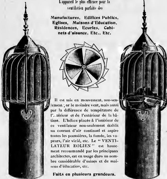
Il est mis en mouvement, non-seulement par le moindre vent, mais aussi par la différence de température de l'intérieur et de l'extérieur de la bâtisse. L'hélice placée à l'intérieur de ce ventilateur non-seulement établit un courant d'air continu et aspire toutes les poussières, la fumée, les vapeurs, l'air vicié, etc. Le "VENTILATEUR EOLIEN" est hautement recommandé par les principaux architectes, est en usage dans un nombre considérable d'usines et de maisons d'éducation, etc.
