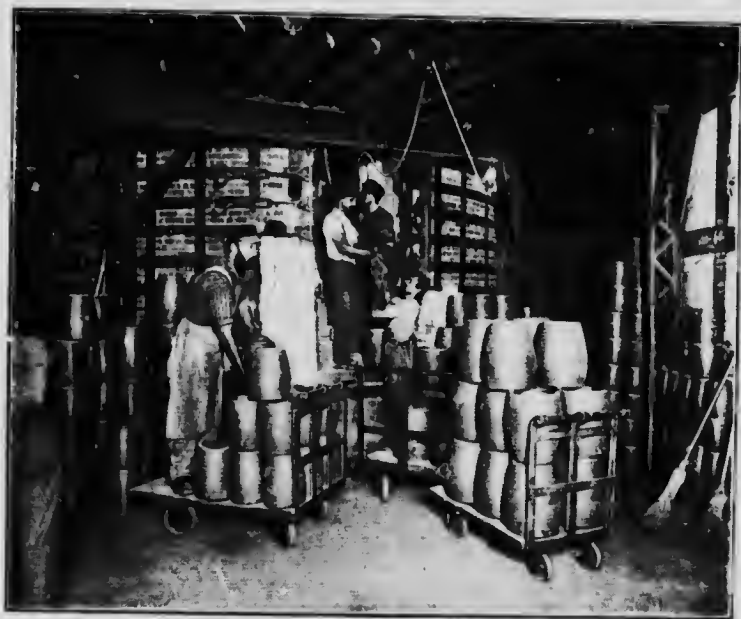
Séchage des creusets dans la fabrique Dixon, Jersey City
