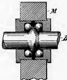
FIG. 3—Détail d'un coussinet convenable aux leviers immobiles et aux bras régulateurs.
