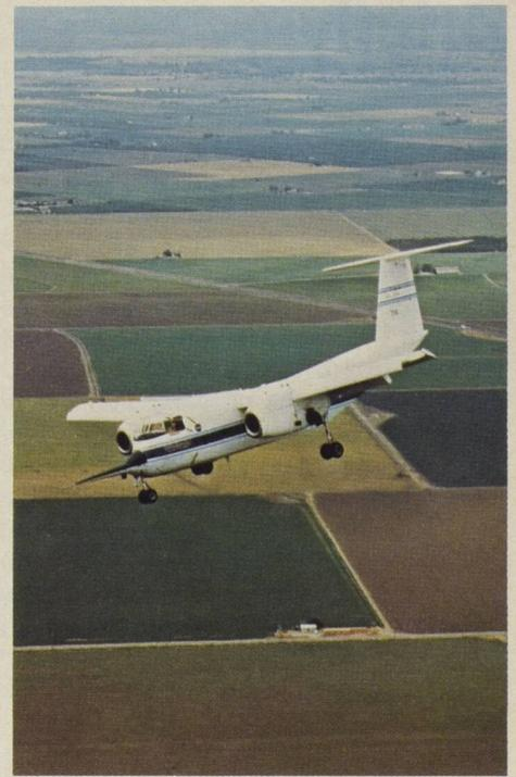
Les résultats obtenus à l'aide de cet avion à aile à volets trompes pourraient conduire à la mise au point d'un nouvel avion ADAC qui serait aussi rapide qu'un avion à réaction. Le laboratoire de recherche en vol a participé avec de Havilland et la NASA au programme conjoint des gouvernements américain et canadien. (NASA)
