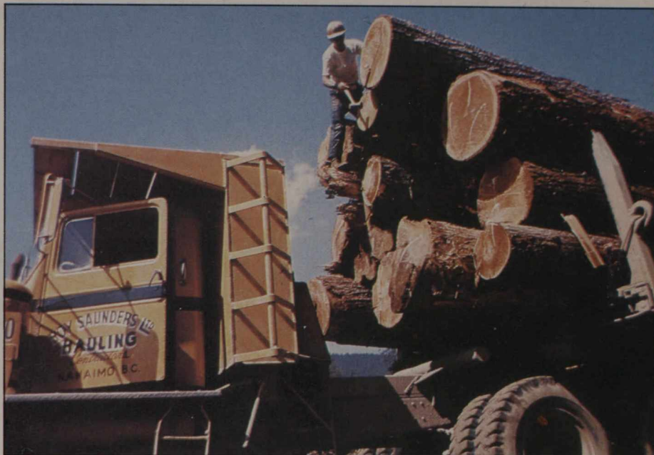
Les billes sont arrimées à la remorque à l'aide de chaînes à crampons.
