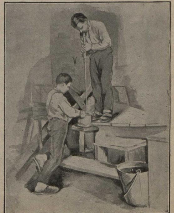
Ouvrier soufflant une bouteille dans un moule.
