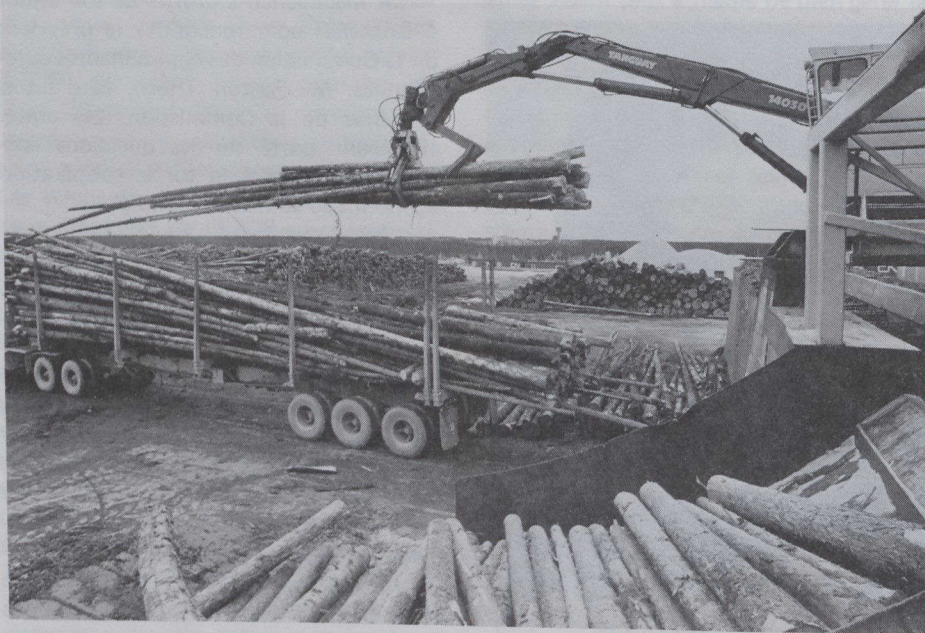
Déchargement d'un camion de Bisson & Bisson et alimentation simultanée de la tronçonneuse hydraulique qui peut découper une quinzaine de grumes à la fois.
