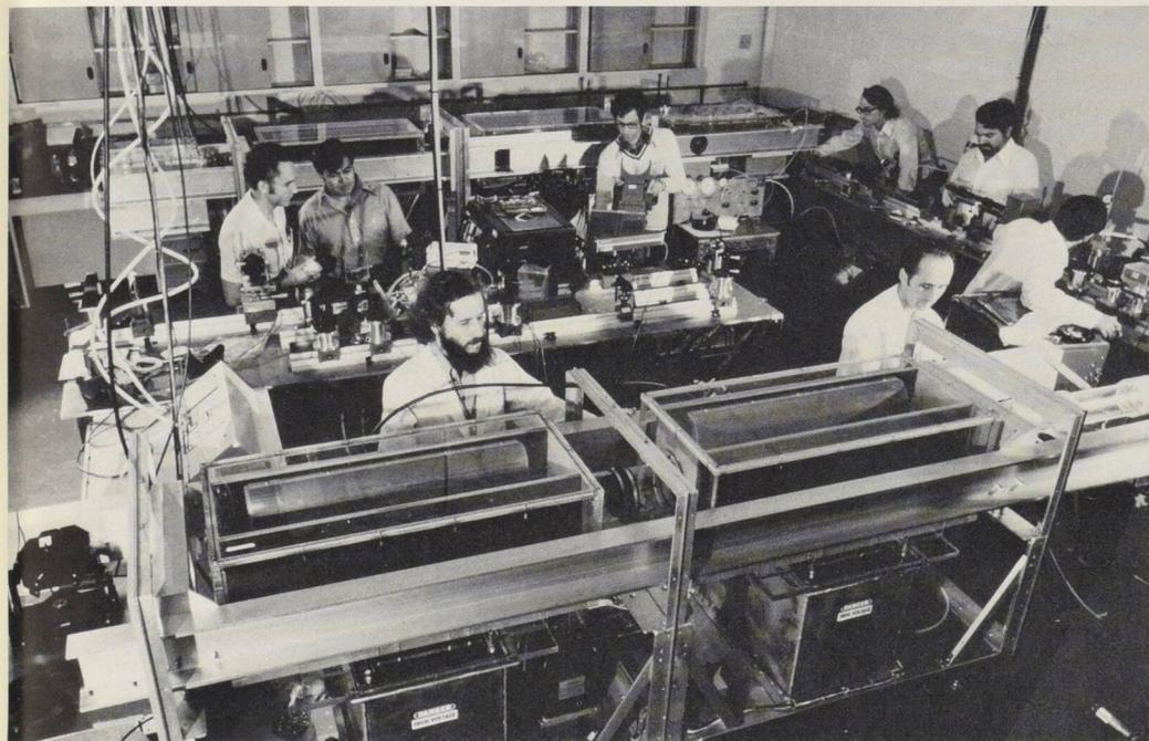
Vue d'ensemble du puissant laser au CO<sub>2</sub> du laboratoire. On peut voir au premier plan deux étages d'amplification du laser.
