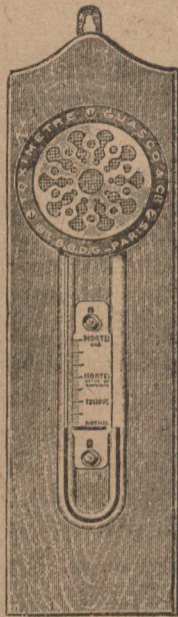
Une simple lecture, analogue à une lecture de thermomètre ou de baromètre, permet de savoir si l'air de la pièce est normal ou plus ou moins chargé de gaz toxique.
