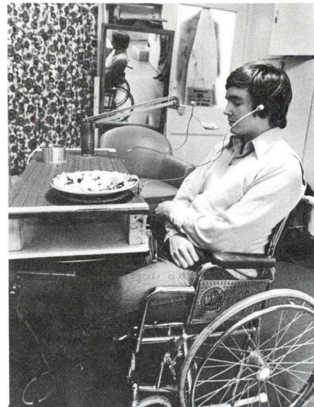
Patrick McNally, étudiant de McGill fait la démonstration de l'"alimenteur" mécanique.
