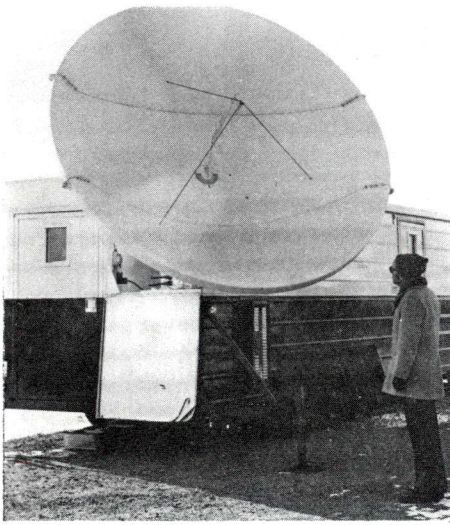
Il est possible de transporter dans une roulotte une station terrestre munie d'une antenne démontable et d'une dynamo.
