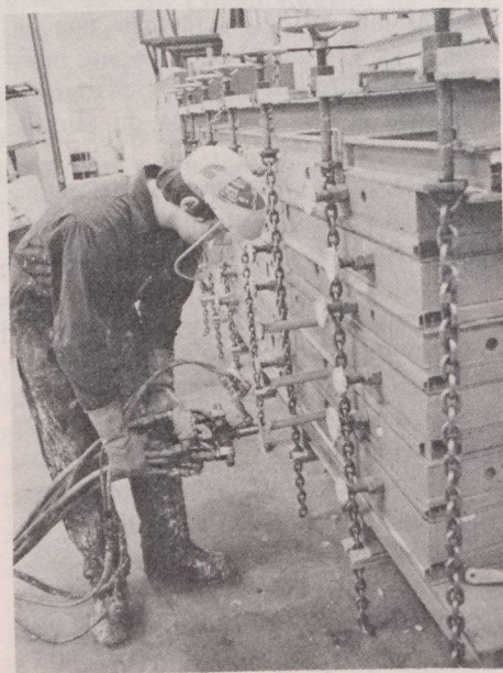
Un employé des Réfrigérateurs Foster injecte de la mousse d'uréthane entre des parois. Cette mousse isole tous les appareils de réfrigération Foster.
