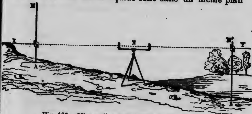
Fig. 166. — Niveau d'eau et opération du nivellement.
