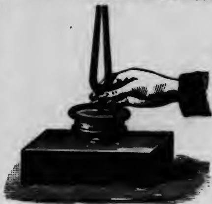
Fig. 182. — Transmission du son par les liquides.
