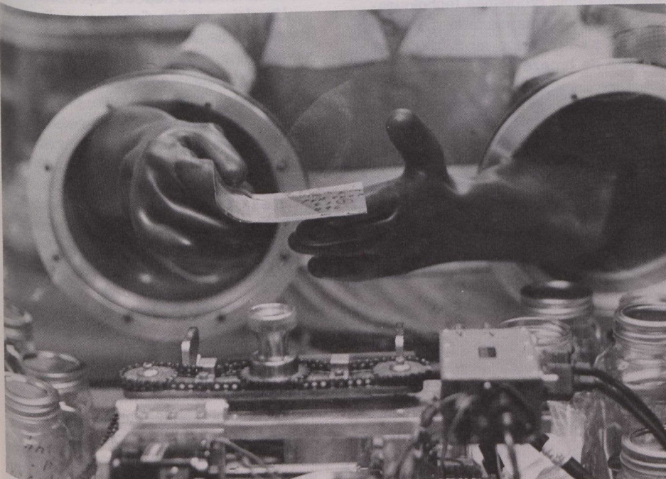
Les accumulateurs à électrolytes polymériques, ACEP, se présentent sous forme de minces « sandwichs » de pellicules très minces. On peut enrouler cet assemblage et en faire une pile complète.
