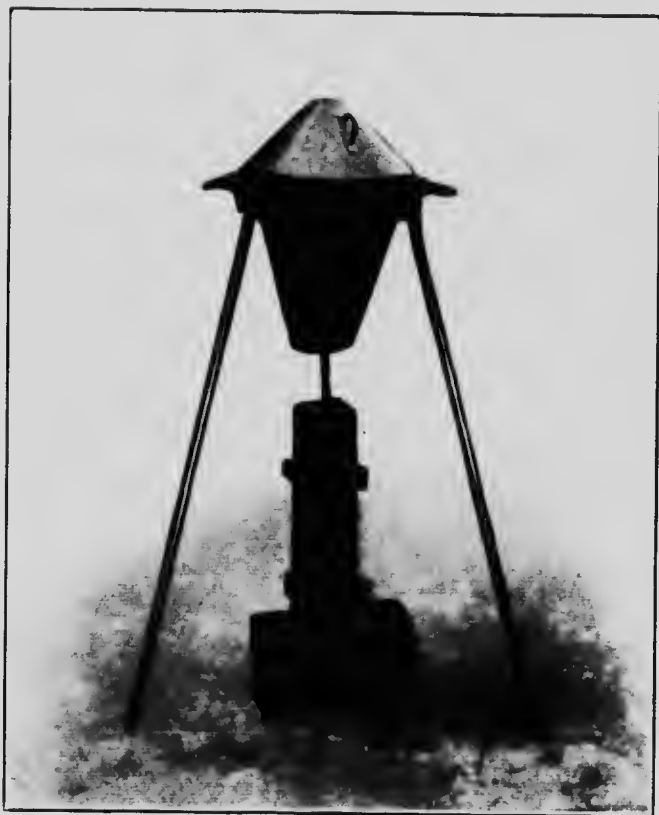
Creuset pour la réduction du \text{Co}_3\text{O}_4 par Al: en position sur le moule
