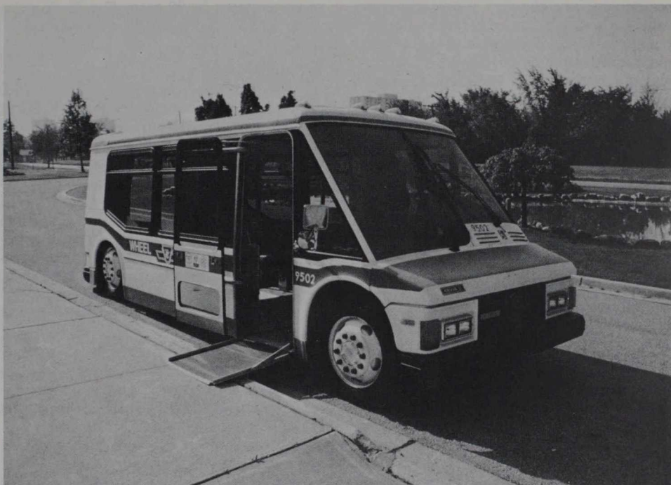
L'Ontario Bus è stato appositamente disegnato per il trasporto delle carrozzelle
