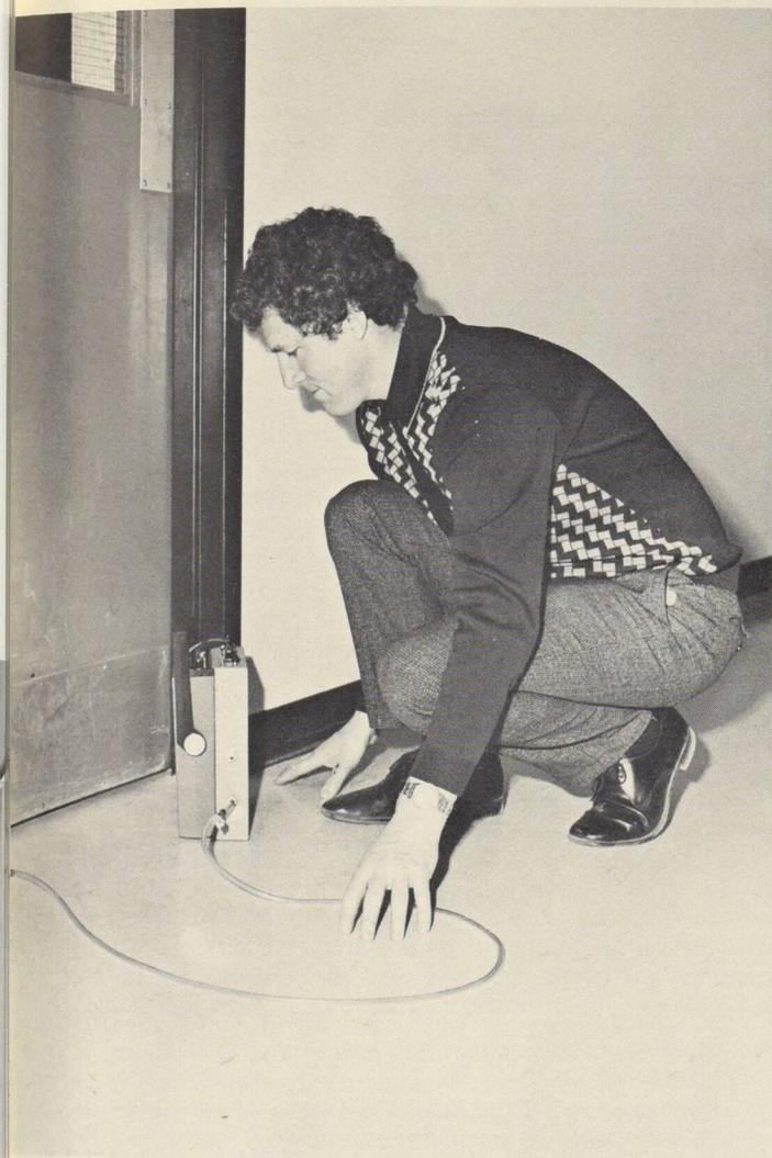
R.G. Evans of DBR employs a strain-gauge diaphragm-type pressure transducer to measure pressure differentials across stair doors. With a given air supply this will determine the extent of stair shaft pressurization. • M. R.G. Evans, de la Division des recherches en bâtiment, utilise un transducteur de pression à extensomètre pour mesurer les différences de pression entre les deux faces d'une porte.
