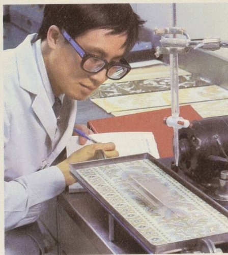
On soumet le papier à des essais en vue de déterminer son taux d'absorption de l'humidité. (Photo: Color Your World)
