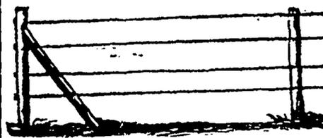
Fig. 10—Treillis à fil horizontal.
