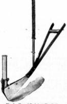
Fig. 6. Shoe of Cockshutt Hoe Drill
