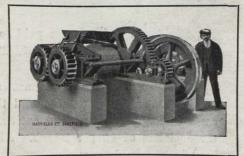
ROLL CRUSHER OF SOLID STEEL CONSTRUCTION
