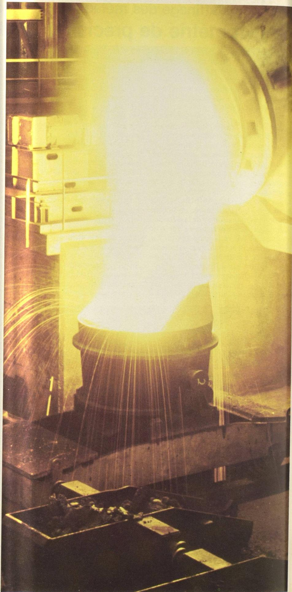
opérations sont effectuées à des températures très élevées (environ 1 300°C) et servent à séparer le sulfure métallique de la roche et du fer. Pendant ces opérations, l'interaction de divers éléments cause des fluctuations dans la quantité d'énergie requise, et c'est pourquoi le Dr Conard et son équipe cherchent à connaître quelles réactions chimiques se déroulent à ces températures élevées.
