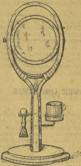
Ainsi qu'on peut s'en rendre compte, cette machine a été fixée dans un socle de bois suffisamment large pour la maintenir verticale et éviter tout renversement. Dans l'intérieur, on a assujéti un miroir rond qui peut pivoter autour de deux axes tournant dans la raquette. L'un de ces axes
