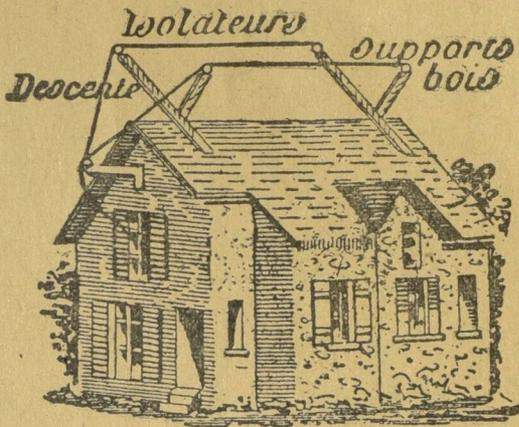
Naturellement, il faut installer des supports, et le moyen suivant est d'une exécution et d'une pose facile, si l'on ne désire pas une antenne très haut placée. Il suffit de préparer des croix en charpente, dont l'angle correspond assez exactement à celui du toit. On prend deux croisillons à chaque bout et autant de supports intermédiaires qu'on le juge utile, si le toit est assez long.
