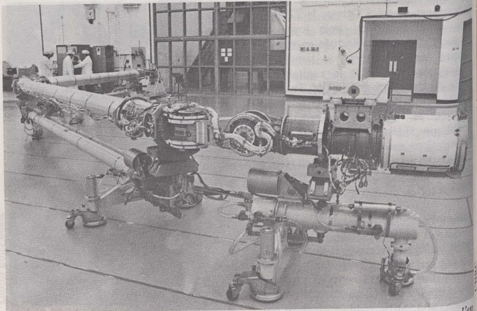
*Le télémanipulateur permettra de placer des satellites dans la soute de la navette et d'en retirer d'autres de l'espace. Sur cette photo, le bras subit un essai de fonctionnement. Conçu pour travailler en apesanteur, il ne peut pas supporter son propre poids sur Terre et doit en conséquence s'appuyer sur des patins pneumatiques spéciaux qui éliminent le frottement pendant l'essai.*
