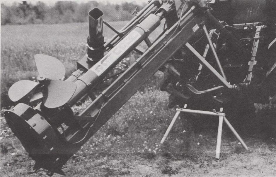
*L'Agi-Pompe mostrada en la fotografía es la primera bomba capaz de transformar estiércol líquido en un abono rico. La empresa J. Houle & Fils Inc., de Drummondville, fabrica esta maquinaria.*
