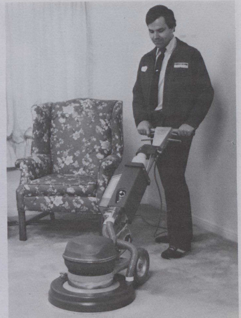
Le nettoyeur-purificateur OZ 1800, fabriqué par Fabri-Zone International Inc., extrait la saleté des fibres de tapis et y injecte une solution à base d'ozone.
